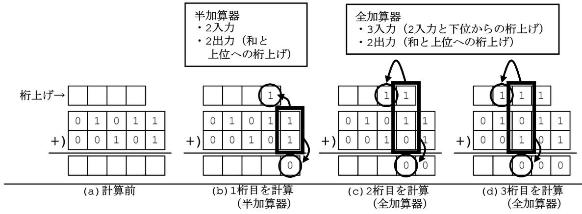
2 進数  $(a_7 a_6 a_5 a_4 a_3 a_2 a_1 a_0)$  と  $(b_7 b_6 b_5 b_4 b_3 b_2 b_1 b_0)$  の加算を行うことを考えよう。i 桁目で、下位からの桁上げ  $c_{i-1}$  とその桁の  $a_i$  と  $b_i$  の計 3 ビットの入力に対して、2 を法とした和  $s_i$  と上位への桁上げ  $c_i$  の計 2 ビットの出力を計算する全加算器の真理値表と各出力の論理式を以下に示す。
