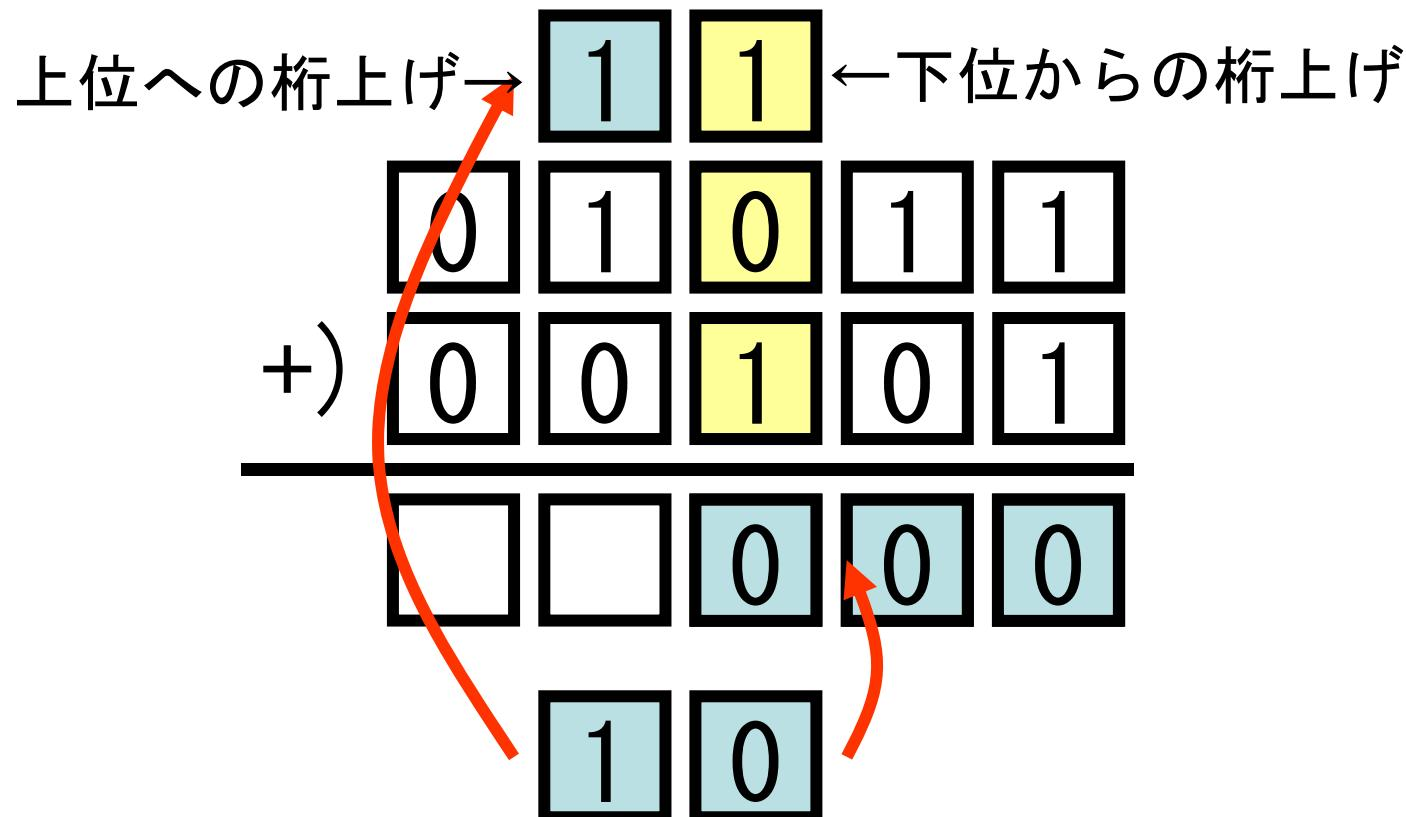
各桁では、入力 3 ビット、出力 2 ビット ⇒ 全加算器
