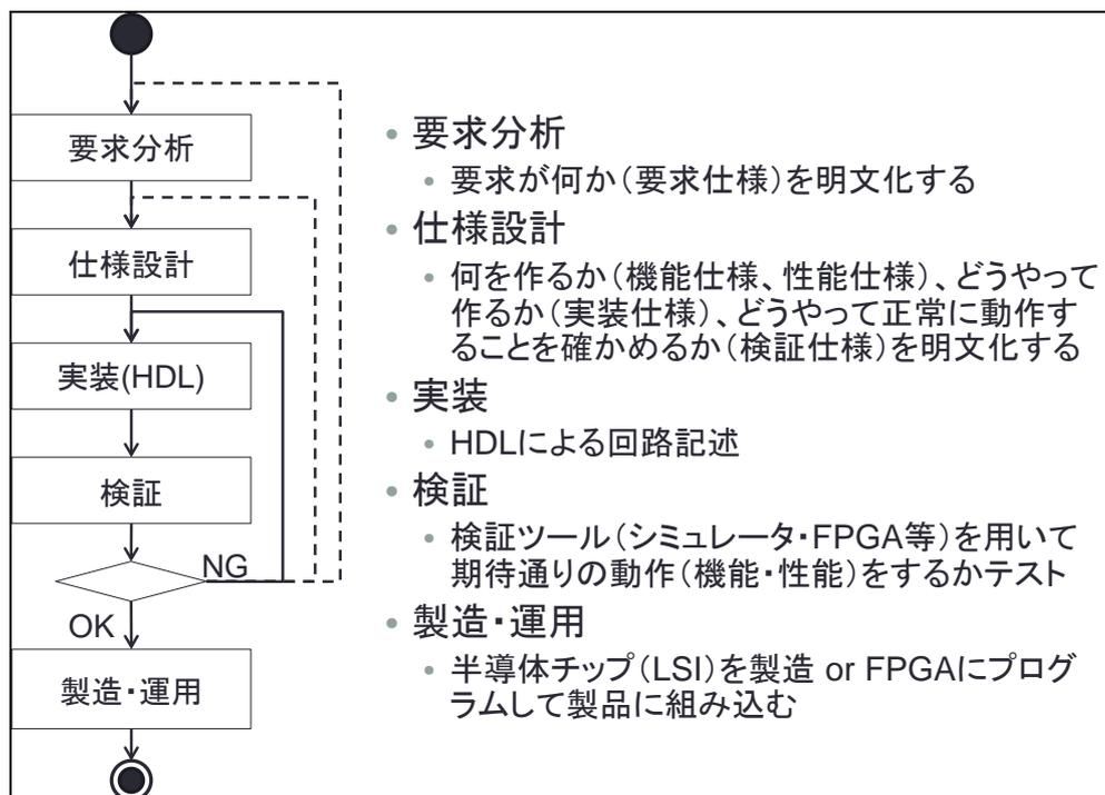
図 1 HDL によるデジタル論理回路設計フローの例 (単純化したもの)
