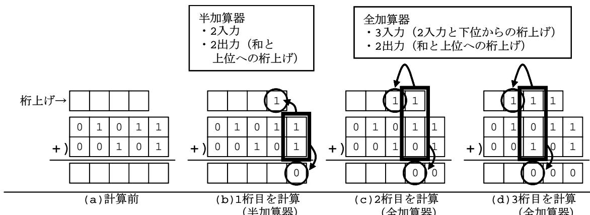
2進数( $a_7 \ a_6 \ a_5 \ a_4 \ a_3 \ a_2 \ a_1 \ a_0$ )と( $b_7 \ b_6 \ b_5 \ b_4 \ b_3 \ b_2 \ b_1 \ b_0$ )の加算を行うことを考えよう。 $i$ 桁目で、
